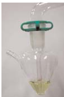
加入氫氧化鈉溶液至溶液顏色呈橄欖綠色
